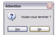
Boîte de message ASK2% avec look intégral Windows XP après intégration du manifeste
